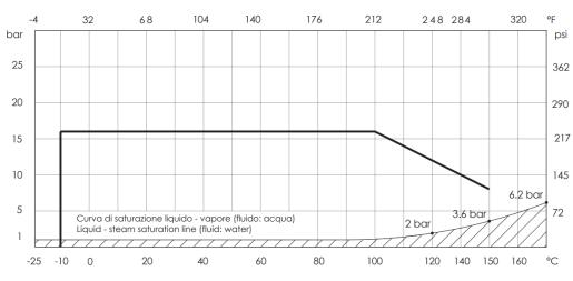
NON ADATTA PER VAPORE. NON utilizzare in condizioni di temperature e pressione al di sotto della curva di saturazione liquido-vapore (area tratteggiata) RANGE NOT SUITABLE FOR STEAM. DO NOT use when temperature and pressure are below the liquid-steam saturation line ( hatched area )
